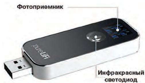
Рис. 9. Специализированный модуль PureLiFi для подключения к сети Li-Fi через порт USB
